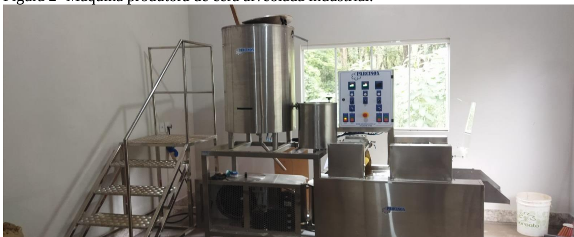
Figura 2- Máquina produtora de cera alveolada industrial.
