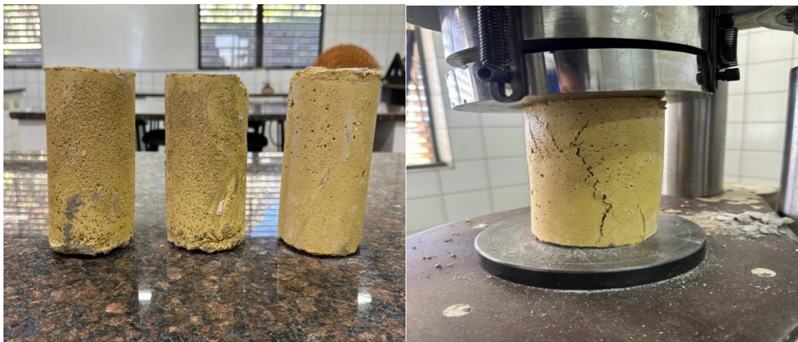
Figura 20: Argamassa catalisada na prensa hidráulica.
