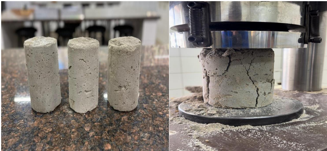
Figura 19: Argamassa convencional na prensa hidráulica.
