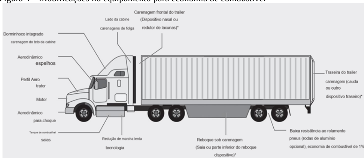
Figura 4 – Modificações no equipamento para economia de combustível
