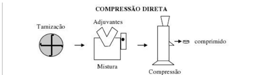
Figura 2- Fluxograma de compressão direta. Fonte: SOUZA; et all, 2006.
