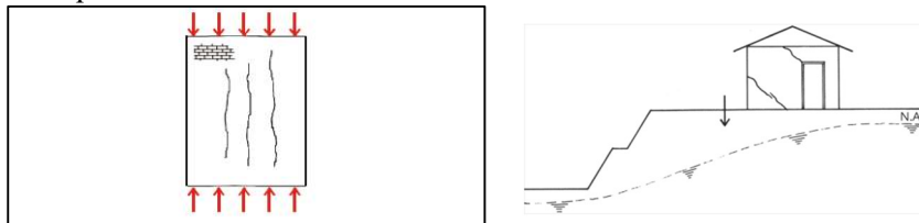
Figura 28: Fissura vertical provenientes de sobrecarga (a sua progressão ocasiona a rachadura) e recalque.
