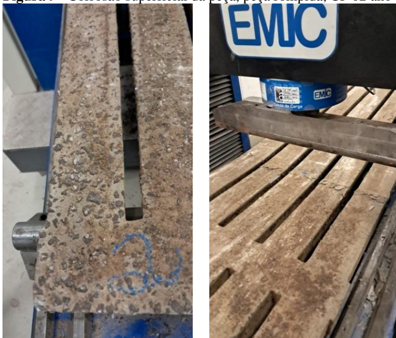
Figura 9 – Corrosão superficial da peça, peça rompida, CP 02 ano 2020.
