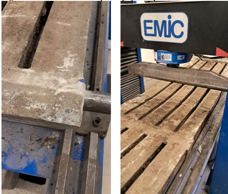
Figura 15 – Avarias de transporte, peça rompida, CP 02 ano 2023.
