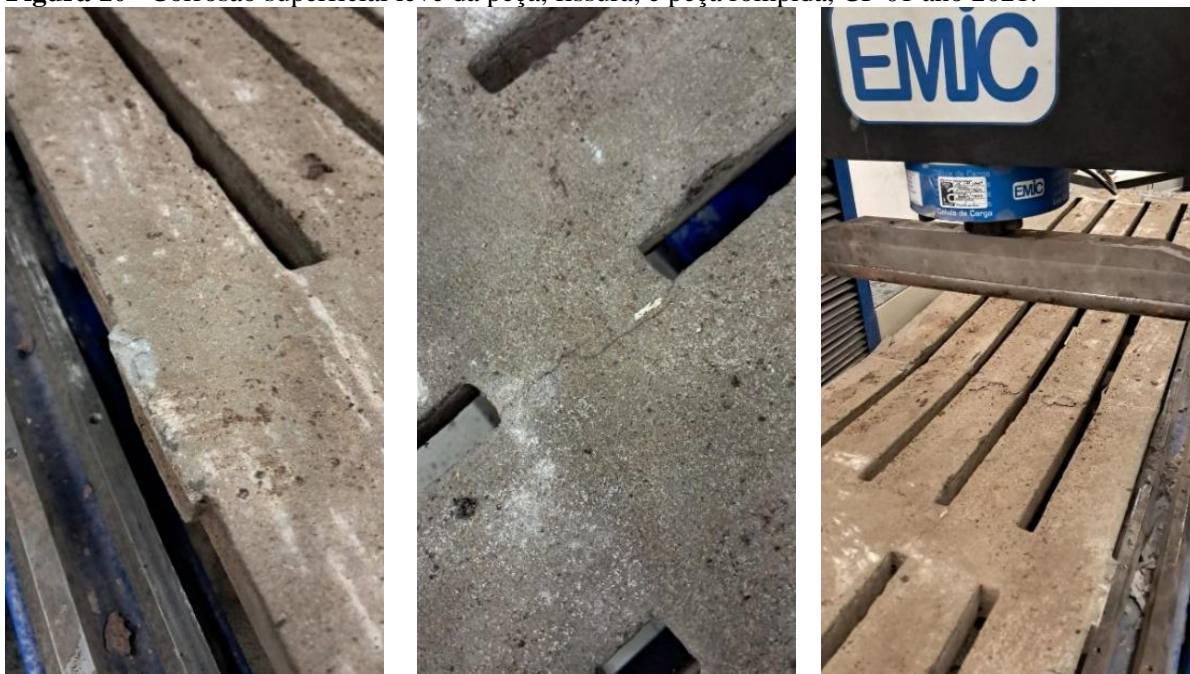
Figura 10 – Corrosão superficial leve da peça, fissura, e peça rompida, CP 01 ano 2021.
