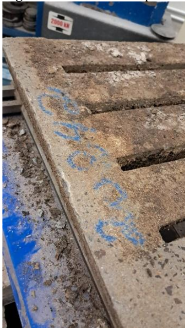
Figura 17 – Corrosão superficial leve, peça rompida, CP 02 ano 2024.
