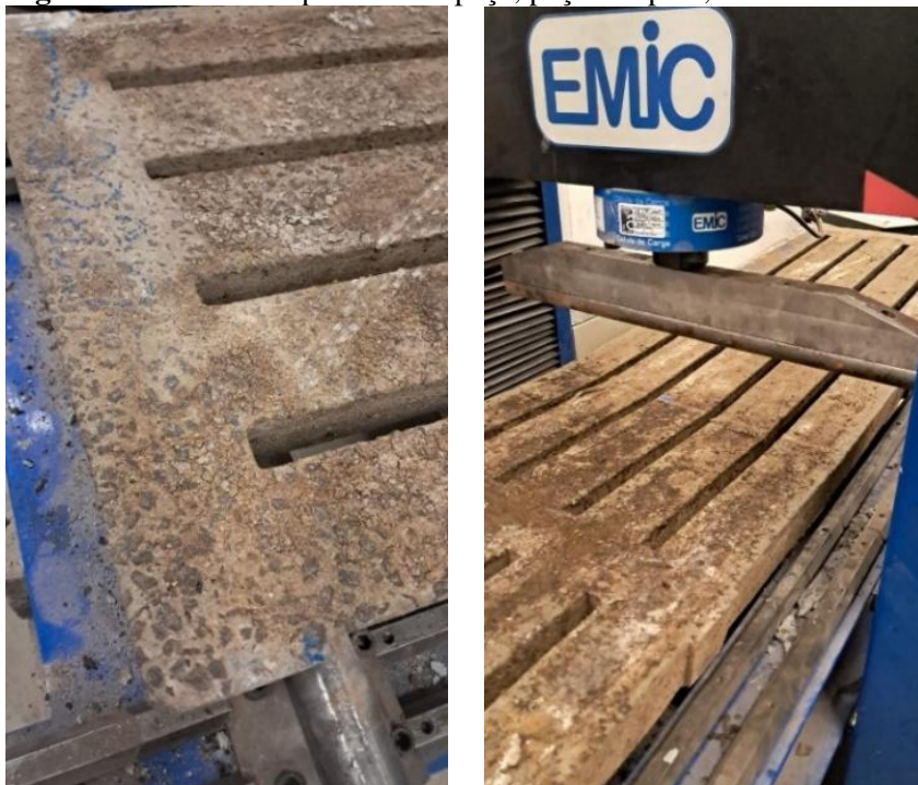
Figura 8 – Corrosão superficial da peça, peça rompida, CP 01 ano 2020.
