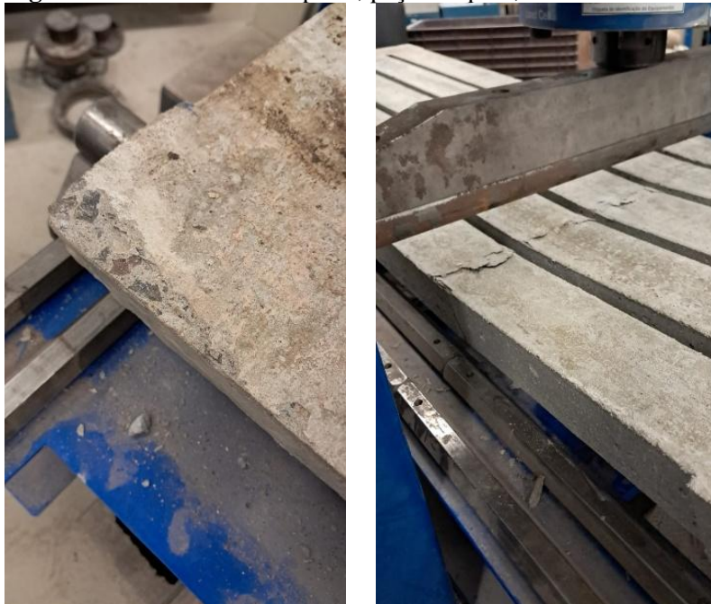
Figura 19 – Avaria de transporte, peça rompida, CP 02 ano 2025.
