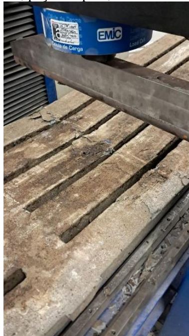
Figura 17 – Corrosão superficial leve, peça rompida, CP 02 ano 2024.
