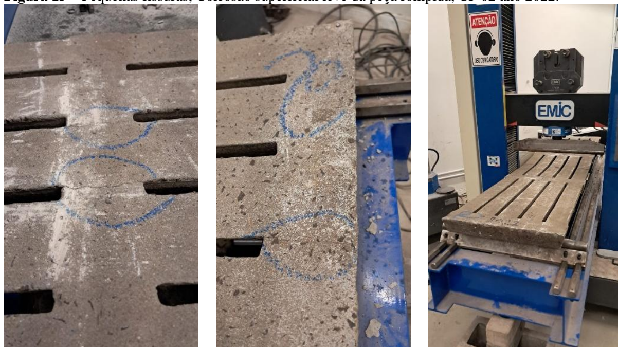
Figura 13 – Pequenas fissuras, Corrosão superficial leve da peça rompida, CP 02 ano 2022.
