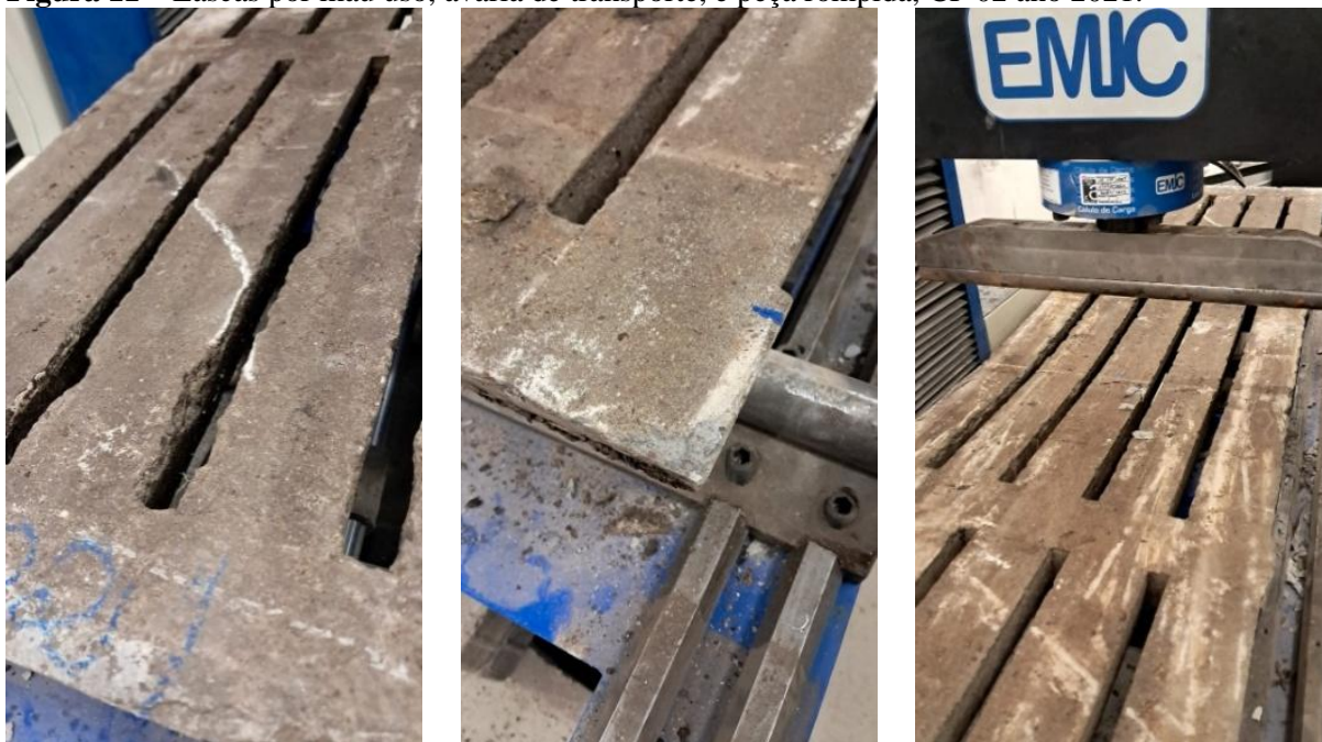
Figura 11 – Lascas por mau uso, avaria de transporte, e peça rompida, CP 02 ano 2021.
