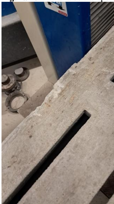
Figura 18 – Avaria de transporte, peça rompida, CP 01 ano 2025.
