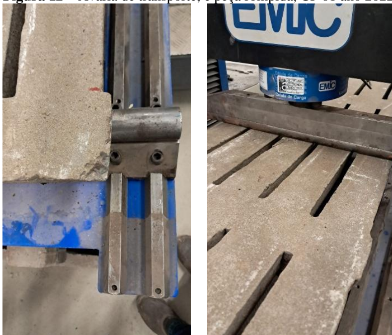
Figura 12 – Avaria de transporte, e peça rompida, CP 01 ano 2022.
