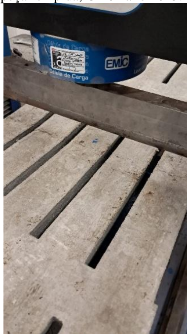
Figura 18 – Avaria de transporte, peça rompida, CP 01 ano 2025.
