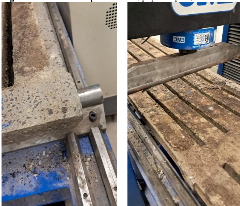
Figura 16 – Corrosão superficial leve, peça rompida, CP 01 ano 2024.
