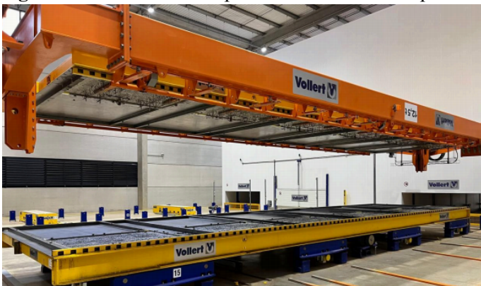
Figura 9 - Processo de acoplamento das faces das paredes com equipamento virador.
