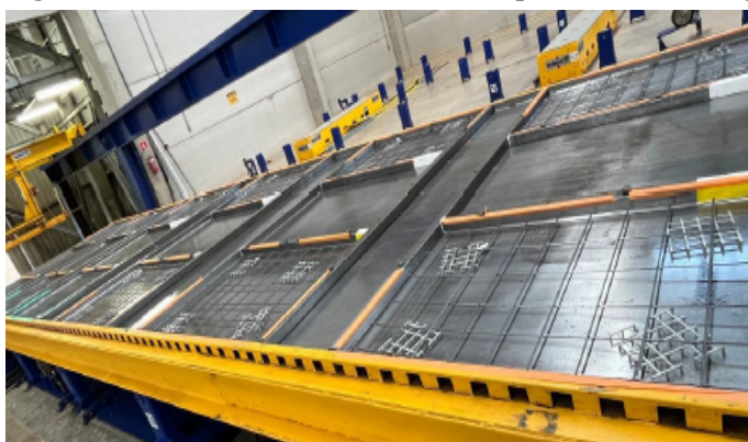
Figura 8 - Método de delimitação da espessura das faces para concretagem utilizando fita colorida.
