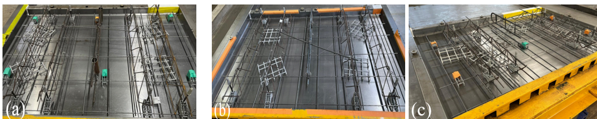
Figura 2 - Modelos de amostras com alças retas. (a) com cordoalha, (b) com barra lisa e (c) barra lisa com barras transversais soldadas.
