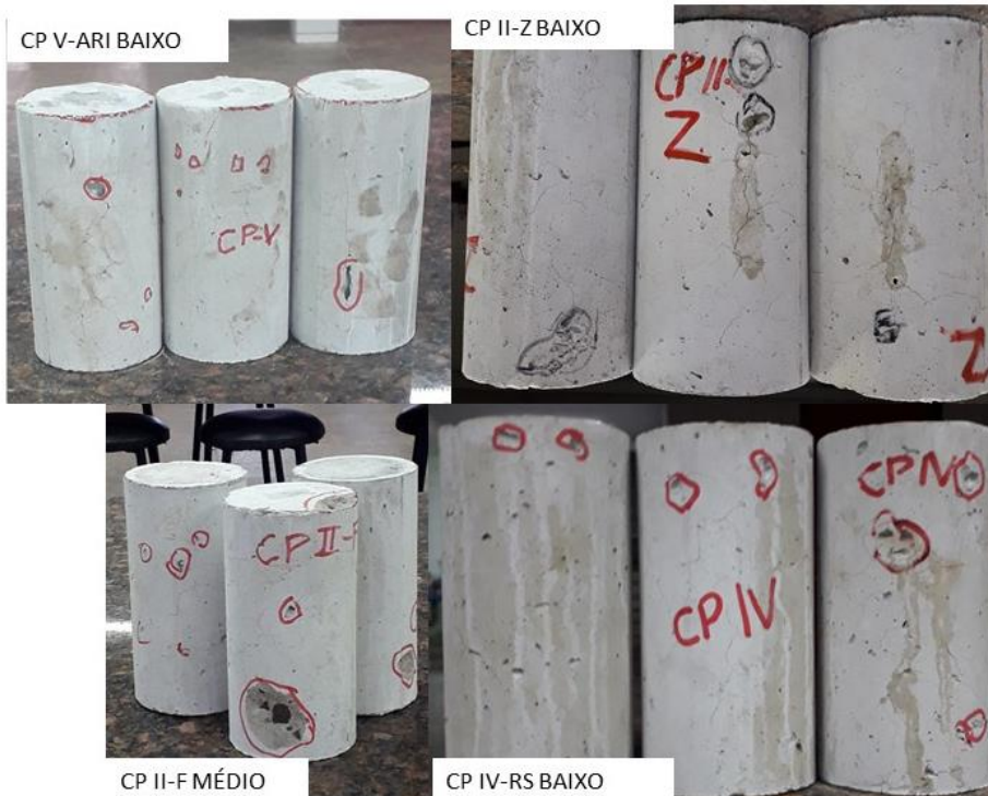
Figura 3: classificação do spalling de acordo com os danos sofridos pelo material
