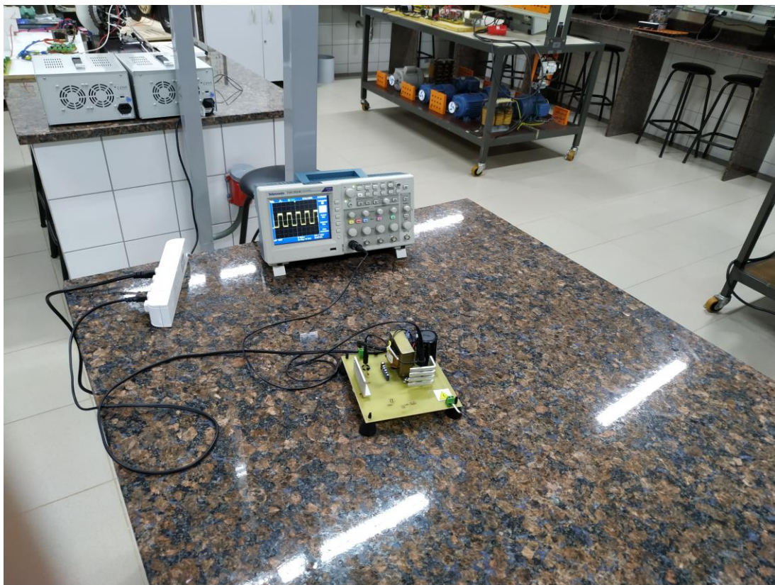
Figura 1 – Flyback conectado ao osciloscópio
