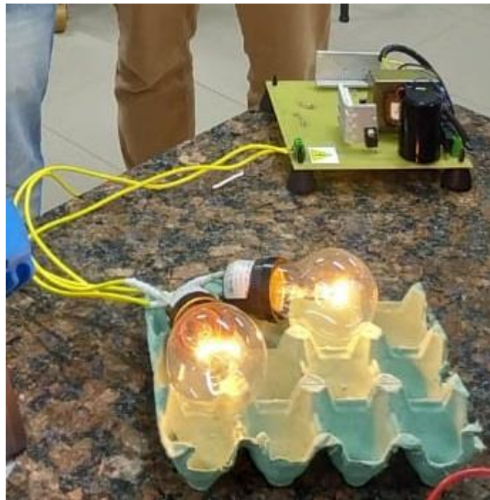
Figura 4 – Flyback ligado em carga: Duas Lâmpadas 127v 40w ligadas em série.
